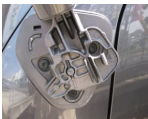
図 4 トルクスネジがでてきますので、3本ミラーが落ちないように手を添えながら外してください。
