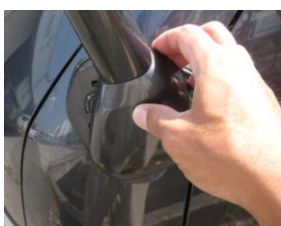
図 3 三角のカバーを手前に引きように、カバー上画像の部分を引きてください。
