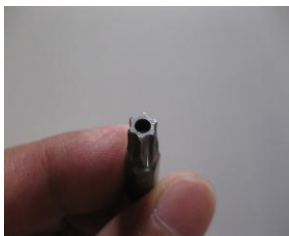
図 5 ★型ネジなので、ホームセンターなどで購入ください。1本は付属されていますが、残り2本は外した2本を使用ください。後は、ネジで固定し三角カバーを慎重に付けていただきミラーを元に戻していただければ作業終了です。
