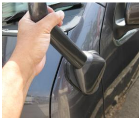
図 1 画像の様にミラーを上を持ち上げてください！ネジ部分がでてきます。
